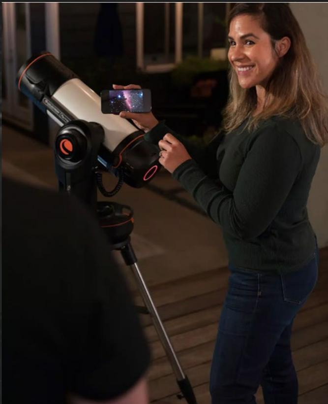
El Celestron Origin se lanzó en 2024, destacándose rápidamente en el mercado de telescopios inteligentes gracias a sus impresionantes especificaciones técnicas y su facilidad de uso. El telescopio cuenta con una apertura de 6 pulgadas y una relación focal rápida de  $f/2.2$ , aspectos cruciales para capturar imágenes detalladas de objetos celestiales. El sistema óptico se basa en el Rowe-Ackermann Schmidt Astrograph (RASA), un diseño aclamado por su eficacia en la astrofotografía.
